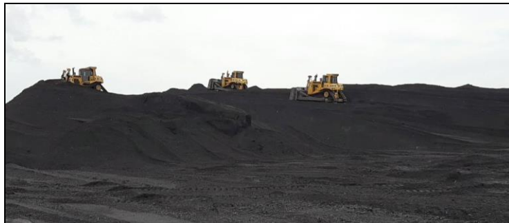
รูปที่ 3 การอัดและตกแต่งกองถ่านหินด้วยรถบิวโตเซอร์
