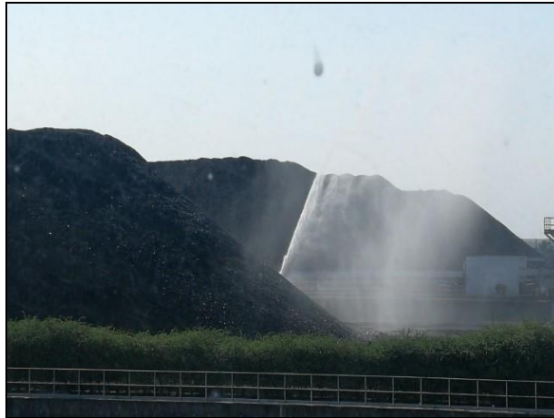
รูปที่ 2 การฉีดสเปรย์น้ำบริเวณลานกองถ่านหิน
