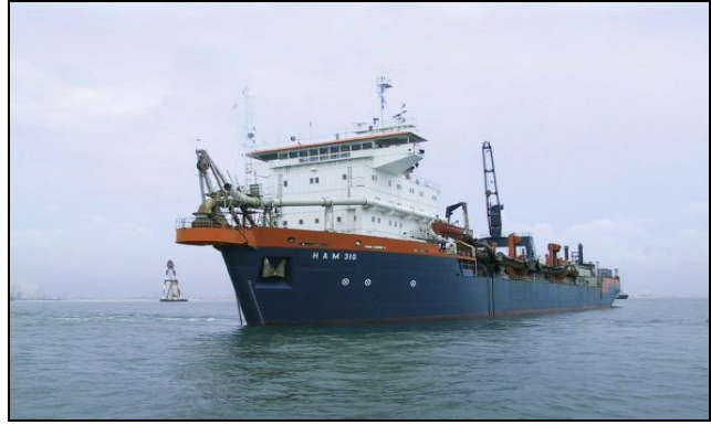
รูปที่ 7 เรือดูดตะกอน (Trailing Hopper Suction Dredger)
