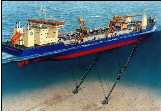
รูปที่ 7 เรือดูดตะกอน (Trailing Hopper Suction Dredger)
