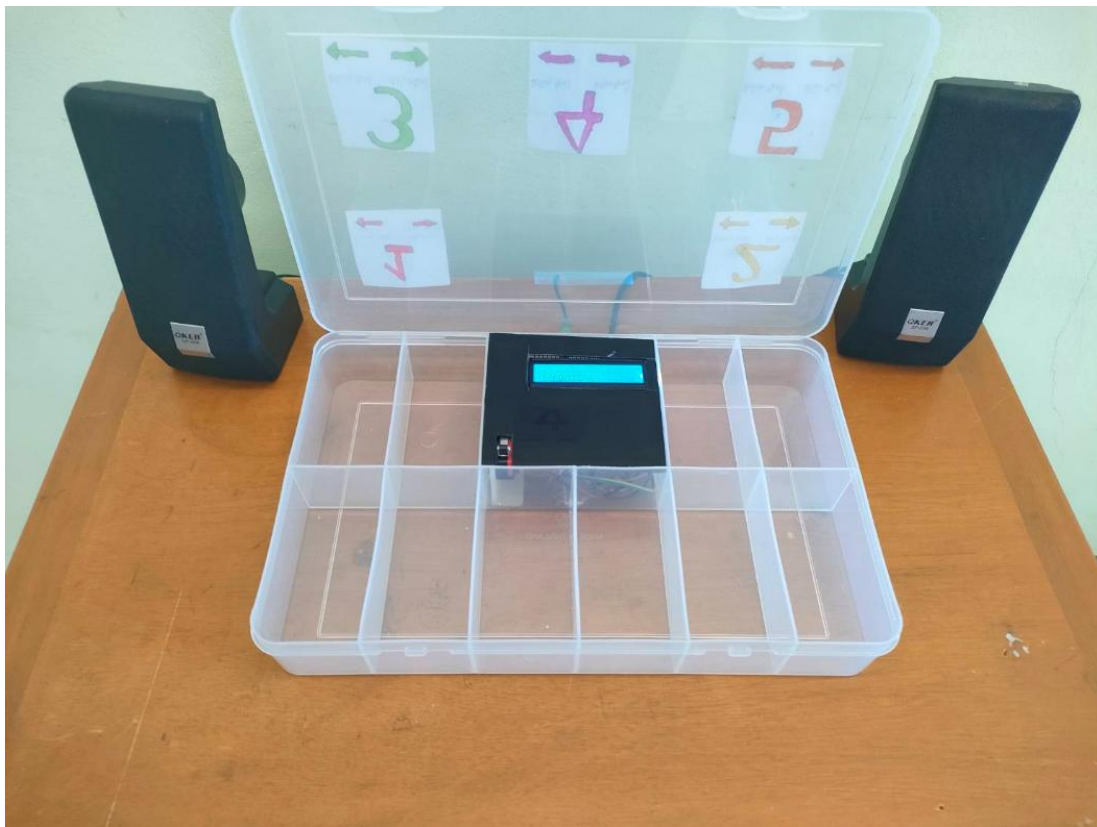
ภาพที่ 3 TIME4MED อุปกรณ์เตือนรับประทานยาด้วยไมโครคอนโทรลเลอร์สำหรับผู้สูงอายุ
