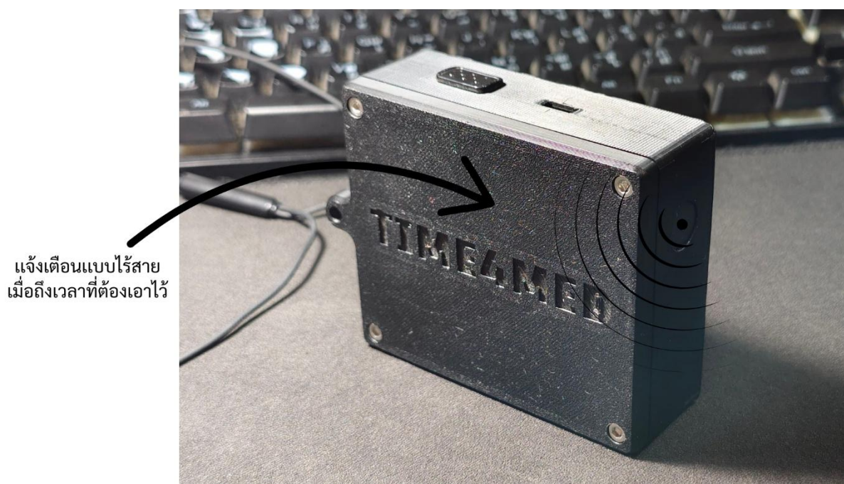
ภาพที่ 7 การทำงานของกล่องเตือนทานยาแบบพกพาสำหรับผู้สูงอายุไทม์ฟอร์เมด (Time4Med)
