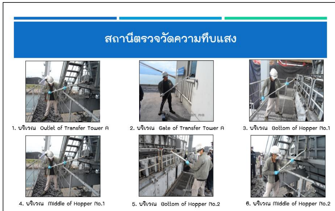
รูปที่ 1 สถานีติดตามตรวจวัดค่าความทึบแสง บริเวณท่าเทียบเรือของโครงการ
